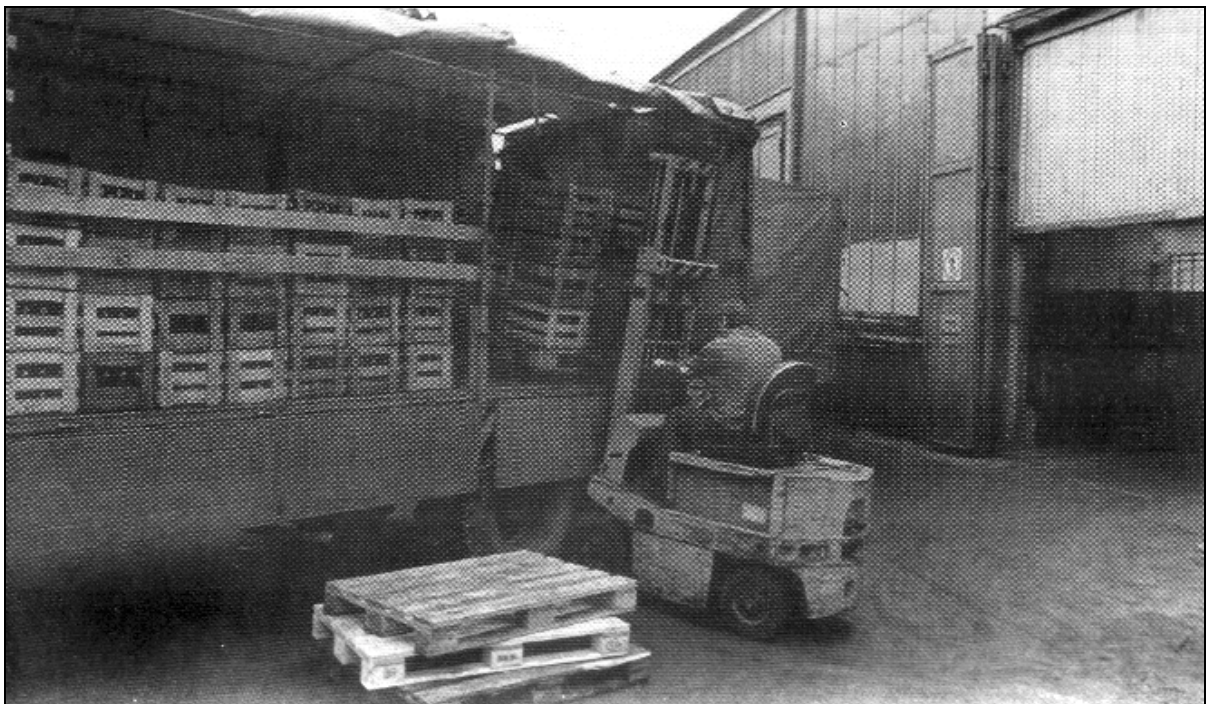
Lkw- Beladung mit Vollgutpaletten
